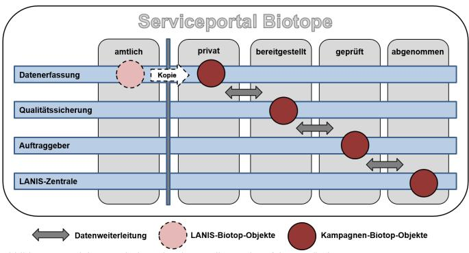
Abbildung 2: Beziehung zwischen einzelnen Rollen und Verfahrensständen
